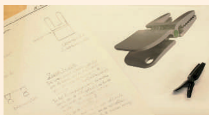
Drie fases in prototyping: ideeomschrijving met lijntekening, 3D-tekening en 3D-geprint prototype
