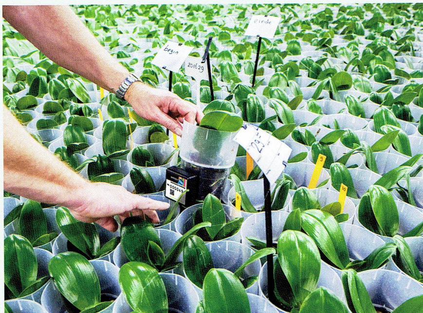
Dit is de pot sensor, in een pot met orchideeën
