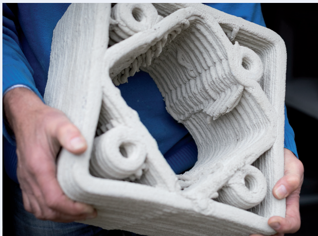
Betonelementen tot 21 kilo. De printstructuur blijft zichtbaar.
